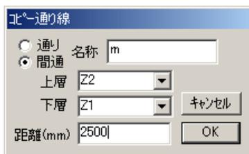
132. この操作で、a 通りの下側 2500 の位置に間通り「m」が作成されました。連続して「間通り」を作成できる状態になっているので、m 間通りよりも下側(点 3 辺り)をクリックします。再度 <コピー通り線>ダイアログが表示されます。
