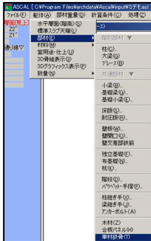
157. <部材リスト入力 - - 単材鉄骨>ダイアログが開くので、「断面寸法」のボタンをクリックして、「部材入力画面へ」をクリックします。
