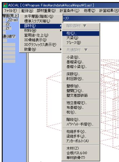
24. <部材リスト入力 - - 柱>ダイアログが開くので、項目選択「一般」の列の「単材かX鉄骨」と「Y鉄骨」のボタンをクリックして、「部材入力画面へ」をクリックします。
